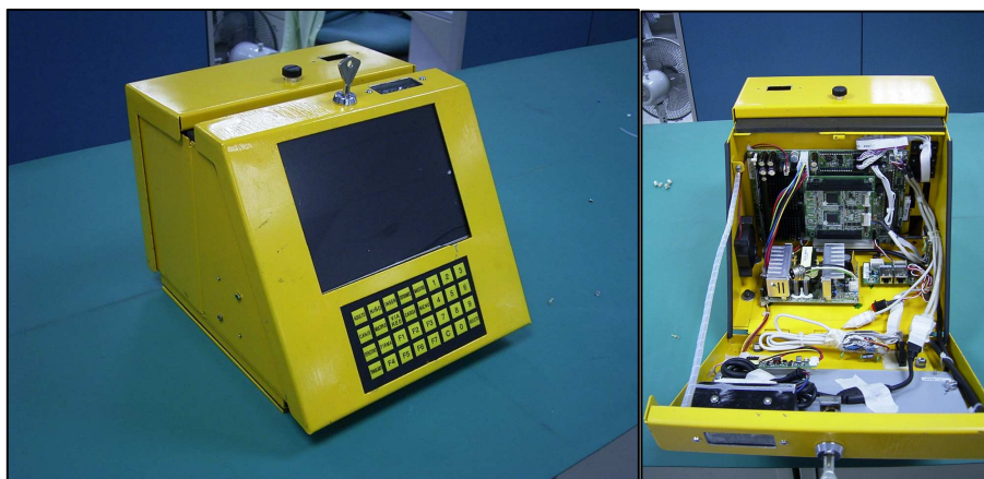
Figura 2.3. Máquina de boletos. Ejemplo de un dispositivo empotrado
