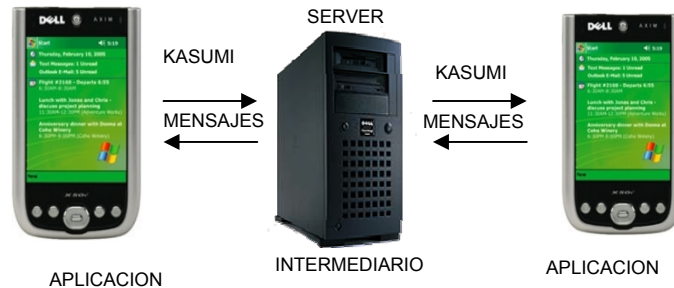
Figura. 4.1. Arquitectura de la aplicación.
