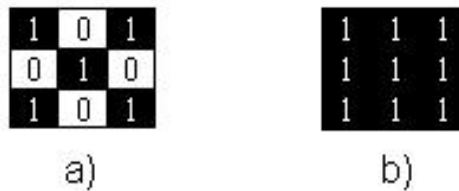
Figura 3.5: Matrices utilizadas para la operación de apertura. (a) para la erosión y (b) para la dilatación.
