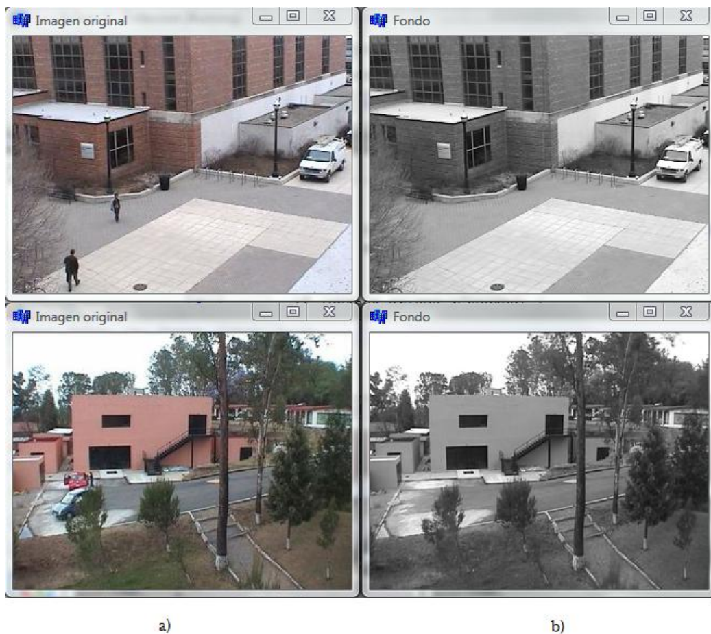
Figura 4.1: En (a) se presenta una imagen de la secuencia y en (b) el fondo adaptable obtenido de la secuencia.
