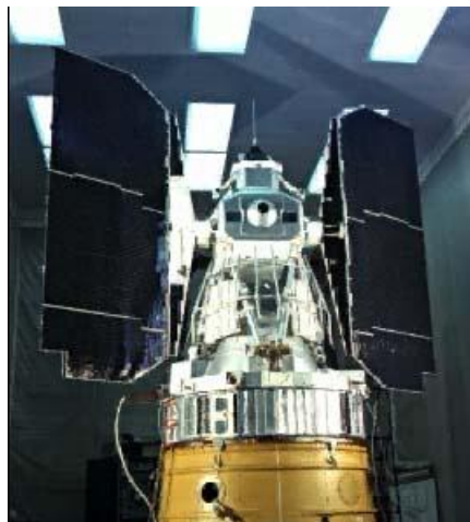
Figura 3.7.7.1 Satélite Nimbus que rodea la Tierra en una órbita que pasa por los polos norte y sur varias veces al día, fotografiando la superficie a su paso. Como la Tierra gira, cada paso produce una nueva serie de imágenes y puede reflejar el planeta entero todos los días [23].
