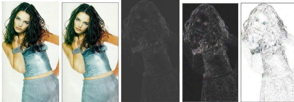
Fig. 2.51 Ejemplo de las operaciones de transformación: a) imagen original, b) interpolación, c) substracción de dos imágenes previas, d) convolución de imágenes substraídas y e) convolución del inverso de la imagen.
