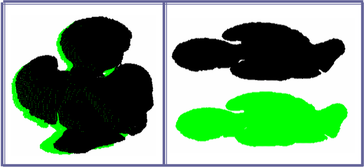
Fig. 45 Conjunto de puntos del modelo P es rotado, para tener la misma orientación que el modelo Q, y lograr la alineación de los modelos. Se tomaron como mínimo 3 parejas de puntos correspondientes a cada modelo, en esta figura se observa que ya se aplico la rotación y la traslación En esta figura se observa claramente que falta aplicar el parámetro de traslación, para lograr la alineación de los modelos P y Q
