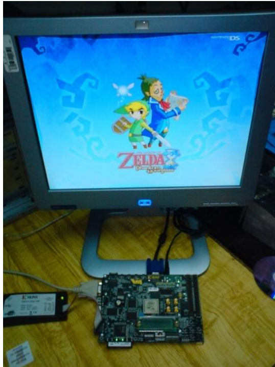
Figura 40. Ejecución del sistema con procesador embebido PowerPC 405, mostrando una imagen a través de la salida VGA.
