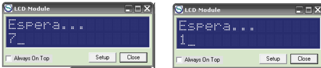
Fig. 6.4, Las imágenes muestran la simulación con el Software PIC Simulator IDE de un contador que en este caso ira de 10 a 0.
