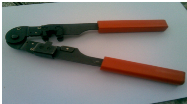
Fig. 20 Pinzas para cortar cable de par trenzado, y para afianzar los hilos de este cable con los conectores Rj-45
