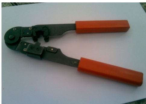
Fig. 4: Pinzas para cortar cable de par trenzado
