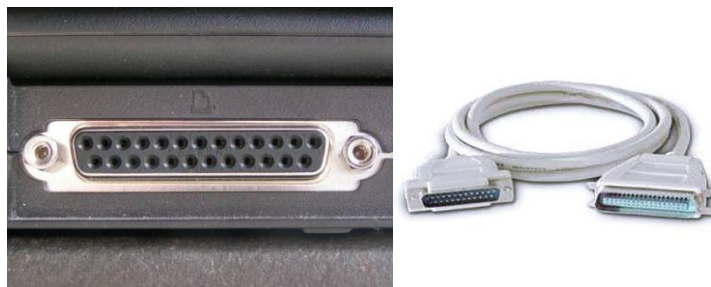
Figura a1. Cable paralelo.
