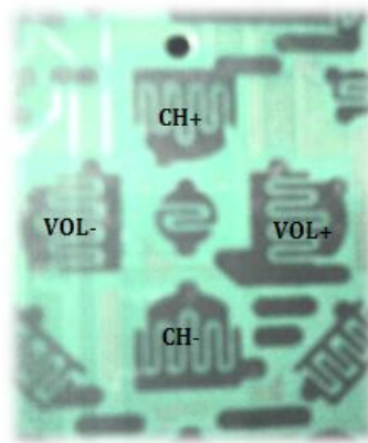
Figura 4.1. Ubicación en la placa del control remoto de las funciones del sistema.
