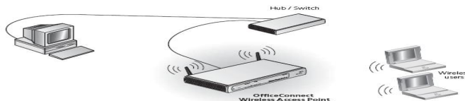
Figura 4.26 Conectando Access Point
