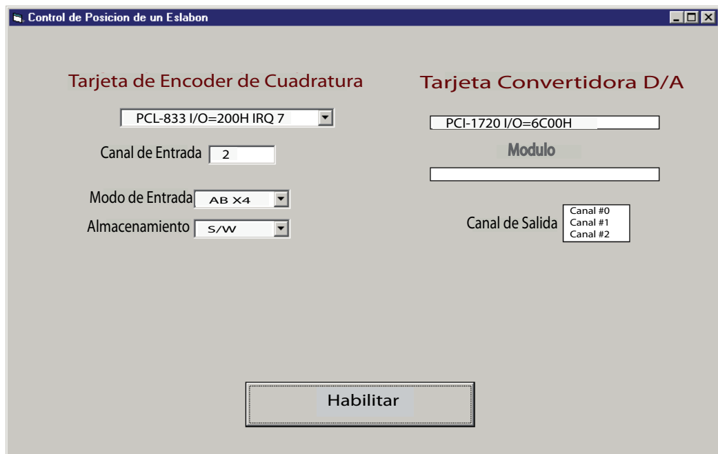
Figura 4.10: Ventana Inicial del Software de Control PI de Posición
