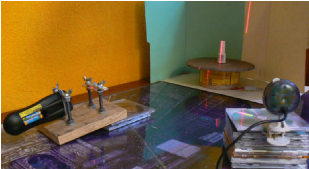
Figura 6.1 Alineación del sistema de digitalización 3D.
