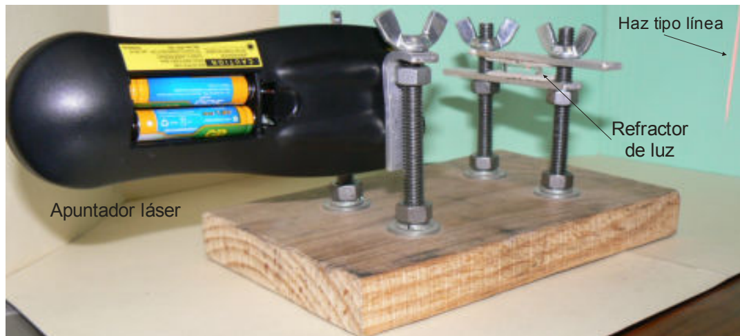
Figura 5.8 Implementación de la fuente de luz láser con lente refractor.
