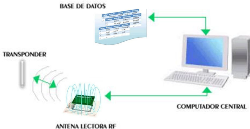
Figura 1.2.1. Elementos básicos de un sistema RFID
