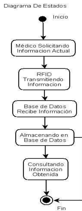
Figura 2.2.7 Diagrama de estados del sistema propuesto
