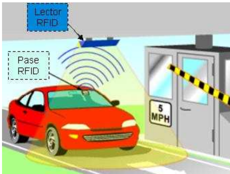
Figura 1.7.1 Un sistema RFID de control de acceso implementado en un peaje
