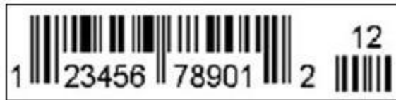
Figura 1.9.9. Ejemplo Código UPC-A con 2 dígitos al final.
