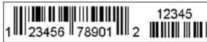
Figura 1.9.10. Ejemplo Código UPC-A con 5 dígitos al final.
