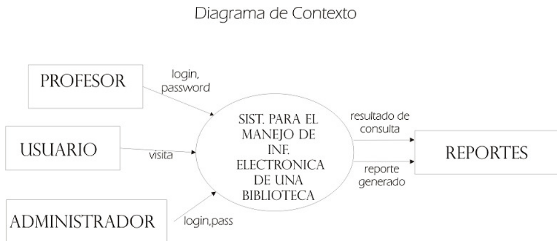
Fig. 3.1 Diagrama de contexto del sistema de base de datos ITZA.
