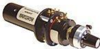
Imagen 2.14. Potenciómetro motorizado, por sus características no resulta idóneo para el objetivo propuesto. [61]
