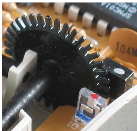
Imagen 2.26. Un encoder dentro del mouse. Como se puede observar existe un diodo receptor y un infrarrojo transmisor emitiendo constantemente y que será interrumpido cada vez que gire el engranaje dentado (movido por la bola del mouse) por lo cual se emitirá un pulso que será enviado a la PC. [71]
