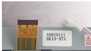
Imagen 2.9. Conector de señal de entrada de 20 pines tipo DF-19L-20P-1H del panel LCD OLED, el costo de este LCD ronda los 18 dólares sin embargo este es su único puerto de salida el cual habría que adaptar. [75]
