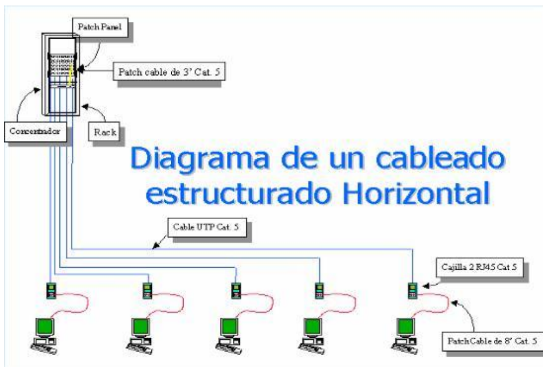
Figura 16 diagrama de un cableado estructurado horizontal
