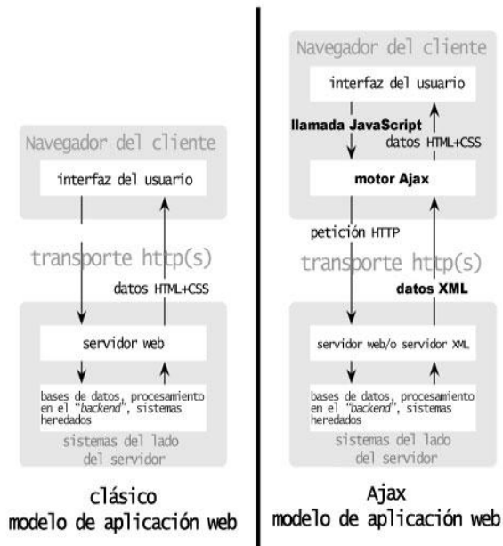
Figura1. 9.- El modelo tradicional para las aplicaciones Web (izq.) comparado con el modelo de AJAX (der.).
