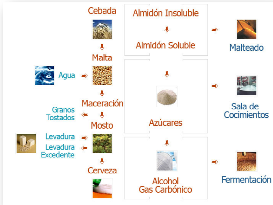
Figura 0.2 Proceso de fabricación de bebidas alcohólicas.
