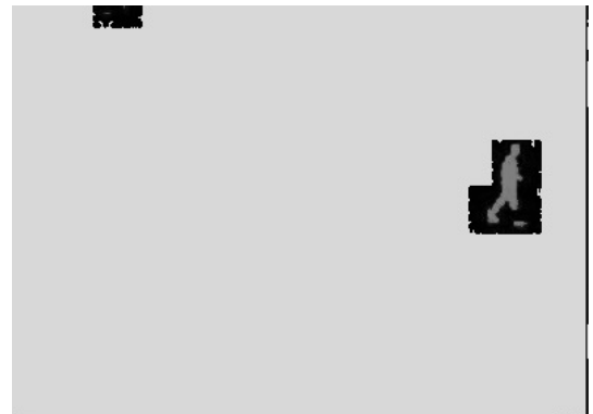
Figura 4.4: Escenario Frontal con la umbralización. Previamente se realizó una sustracción
