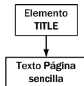
Figura 2.9. Nodos generados automáticamente por DOM para una etiqueta XHTML sencilla.
