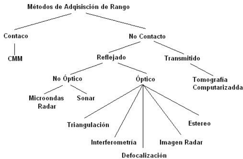
Figura 17. Taxonomía de los métodos de adquisición de rango activo
