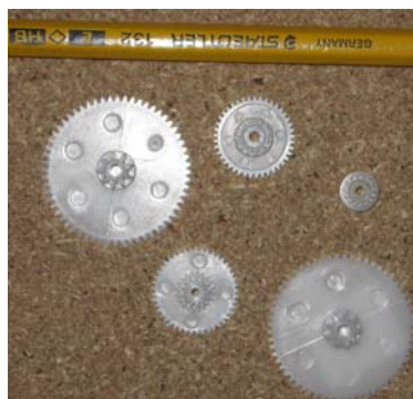
Figura 3.3. Engranés de plástico utilizados para la construcción de los módulos del robot
