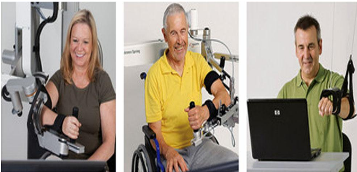
Figura 2.2 Distintas variantes de ARMeo ; en la primera imagen esta ARMeo Power , en la segunda esta ARMeo Spring y la tercera es ARMeo Boom .
