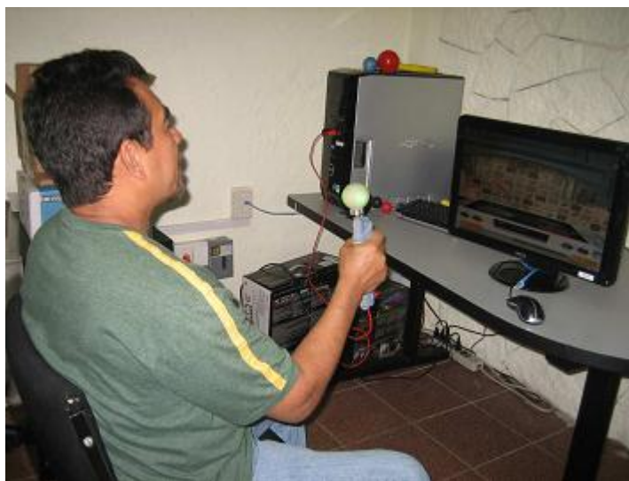
Figura 2.11 El paciente se coloca enfrente del equipo donde se encuentra la cámara web y este interactúa con los juegos por medio del grip-er conectado al equipo.
