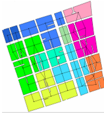
Figura 3.9: Grafo Uniforme generado con Triangulación de Delaunay. (Romero, 2002)
