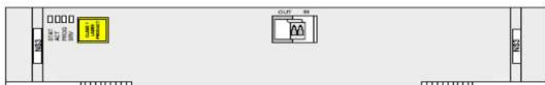
Figura 3.4.9 Unidad de Línea con un puerto de 40gb [12] .
