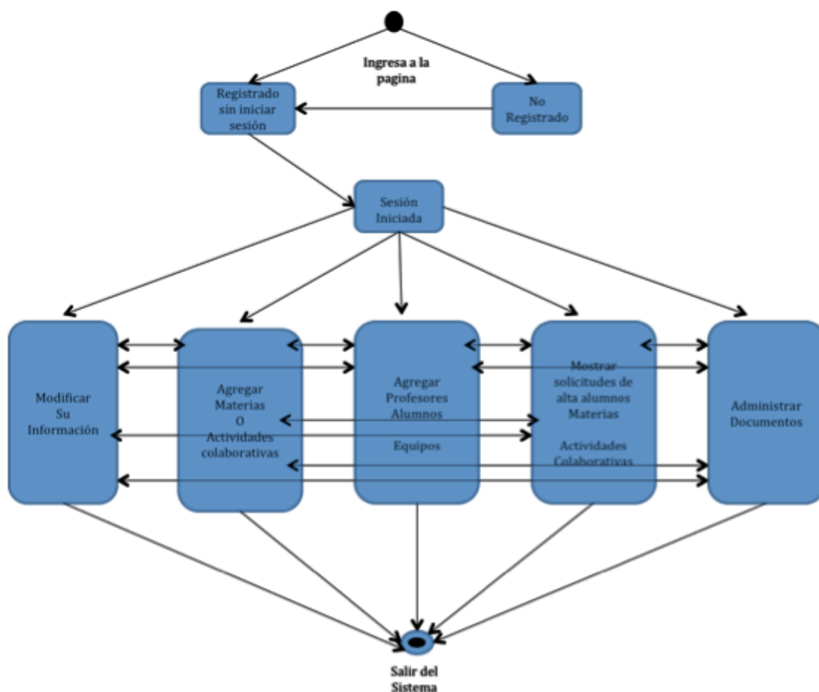
3.7.1 En este diagrama se puede apreciar cada una de las funciones a las que pueden acceder los usuarios en el sistema web.
