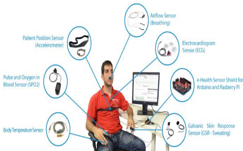
Fig. 16. Colocación de sensores en el usuario
